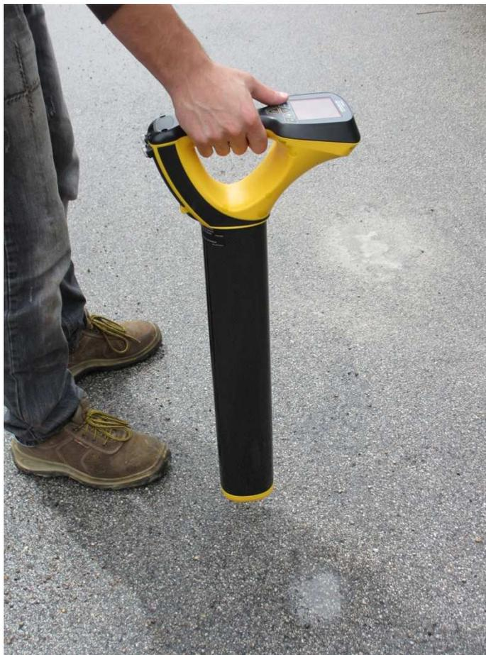
Mediante un trasmettitore di frequenza locato nella *telecamera* ed un localizzatore esterno i ns. tecnici specializzati sono in grado di rilevare il percorso della rete, la presenza di camerette interrate con determinazione della profondità.
